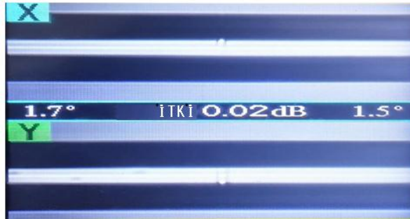
Şəkil 1. Tozlu havada FO kabel birləşməsi. (Dusty cable joint)
